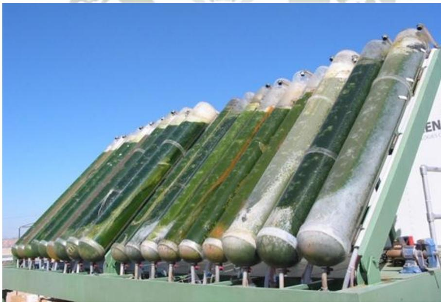
**Figura 8. Fotobiorreactor tubular. (Fuente: Ami Ben-Amotz et al., 2009)**
