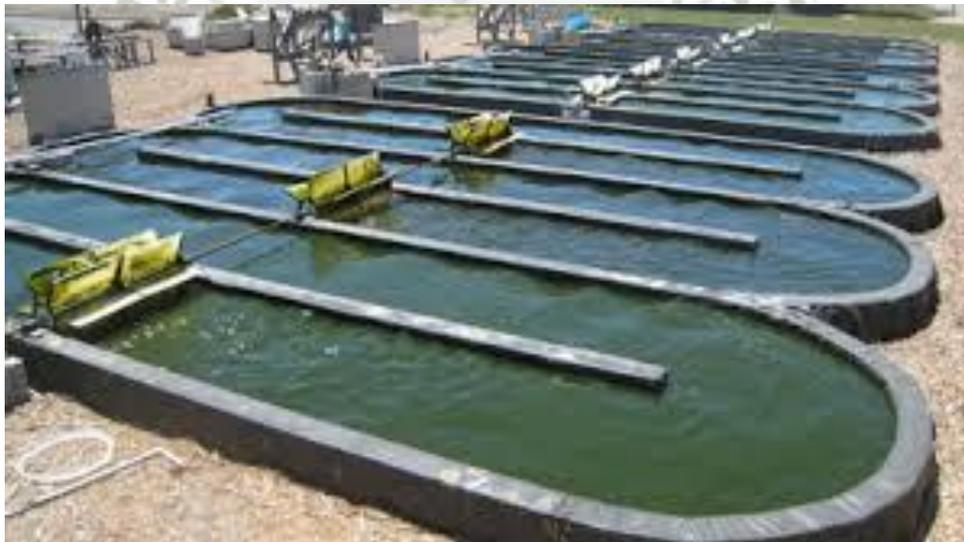
**Figura 9. Sistema abierto de cultivo que muestra una estanque con rueda de paletas (Ami Ben-Amotz et al, 2009).**
